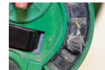
SUCIEDAD Y RESTOS EN LA TOMA DE AIRE
